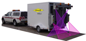
FIGURE: Dispositif contrôlant la chaussée
